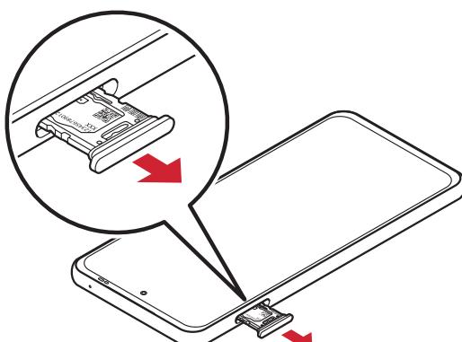
③ nanoSIM カードの IC 面を上にして切り欠きをスロットキャップ側に向けた状態で、スロットキャップのトレイ (nanoSIM カード) にはめ込む
