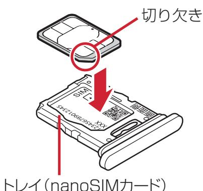
④ 本端末のディスプレイ側が上に向いていることを確認して、スロットキャップをまっすぐ水平に差し込む
